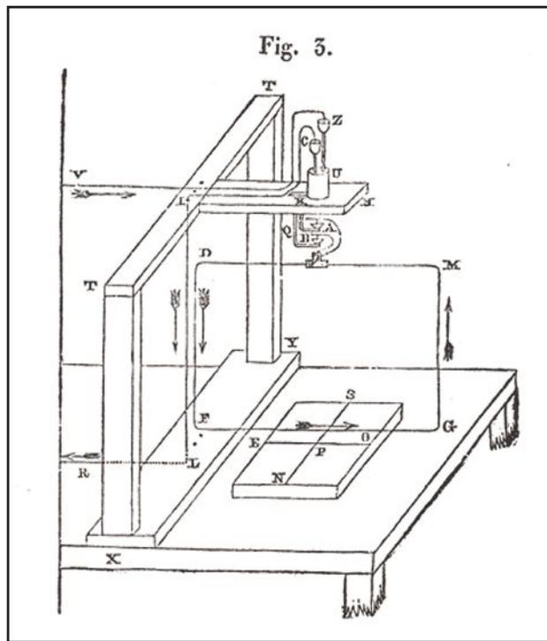
An experimental apparatus used by Ampère. From Ampère, “Exposé des Nouvelles Découvertes sur L'Electricité,” 1822.
